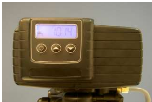
Automatiken har inbyggd förbigång samt hårdhetsregulator, vilket man kan ställa in önskad hårdhet på utgående vatten. Ventilen är tillverkad av noryl. Timern är elektronisk och matas med en medföljande skyddstransformator (24V).
